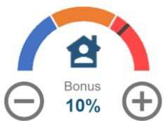
Les touches "+" et "-" permettent d'ajuster facilement la courbe de chaud. L'ajustement est proportionnel au résultat de la courbe de chaud.
